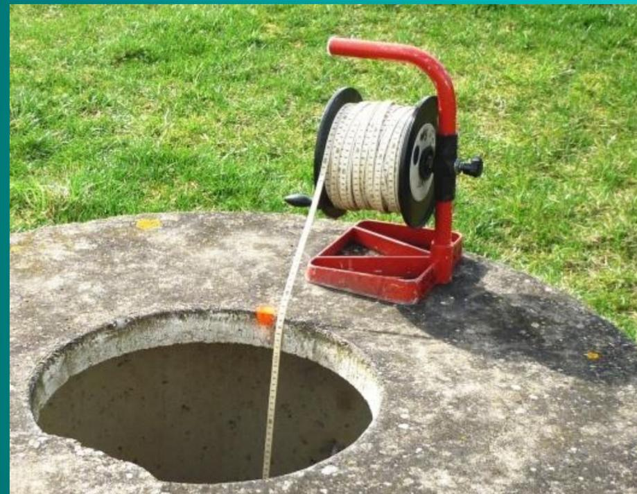
Mesure du niveau d'eau à l'aide d'une sonde manuelle et du ruban métré (@BRGM)
