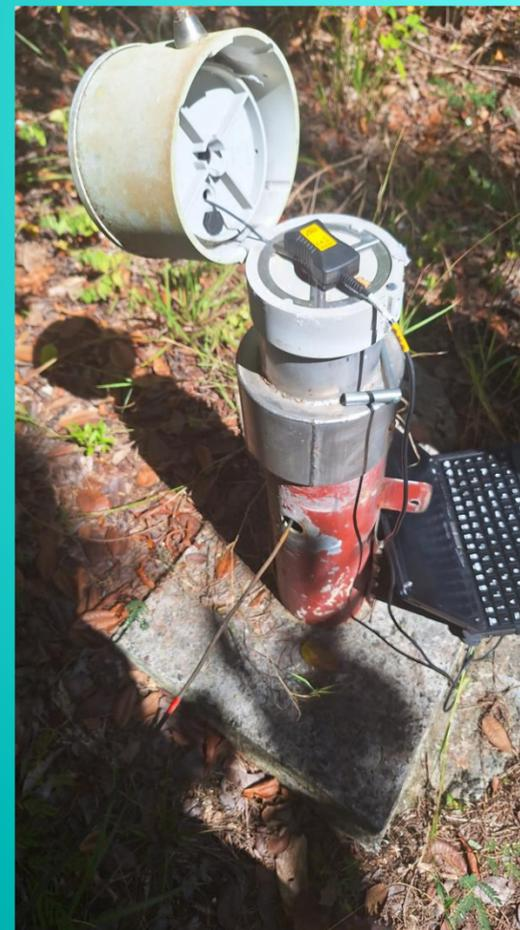
Déchargement des données de terrain – sonde OTT (@BRGM)
